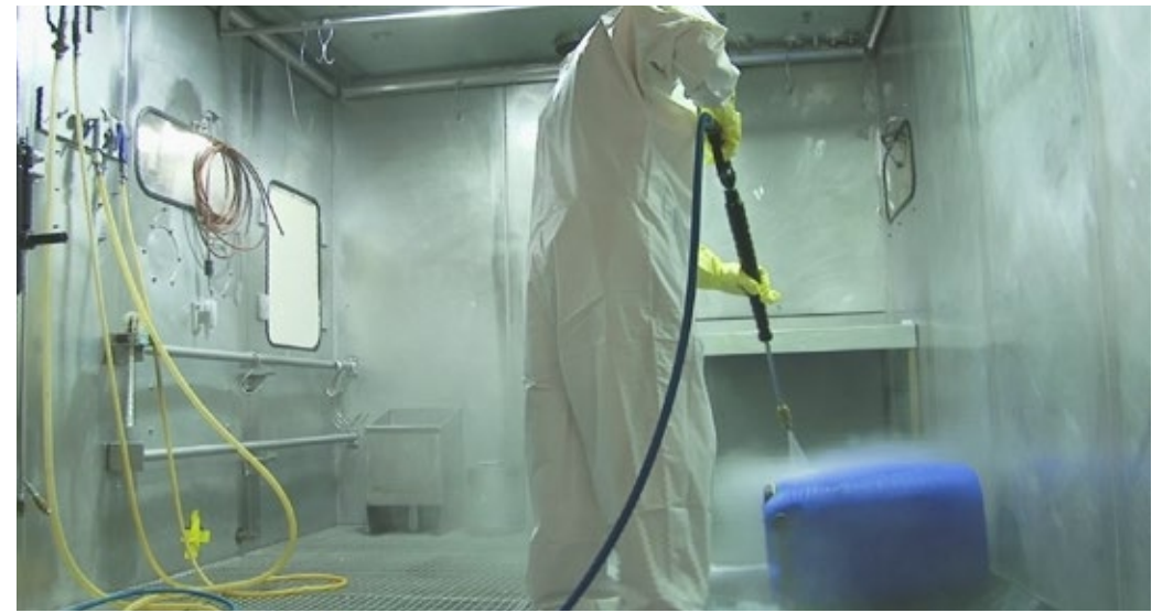
Die Dekontbox ist eine Einrichtung zur Dekontamination von Gegenständen, also zur Entfernung von radioaktiven Verschmutzungen.
